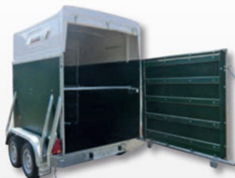
Rückwärtige Bordwand seitlich aufgehend oder als Aufstiegsrampe
