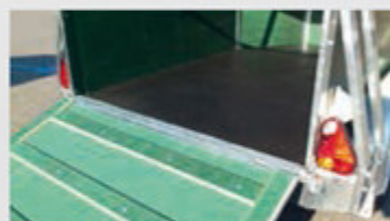
Estrich-Gummiboden und durchgehendes Rohrscharnier
